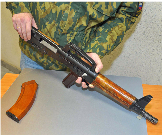
2. Снять крышку кожуха, для чего нажать на защёлку крышки и снять крышку вперед вверх, открывание крышки и осмотр автомата производится в любом положении подвижных частей
