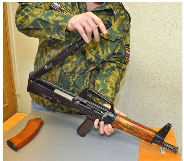
2. Снять крышку кожуха, для чего нажать на защёлку крышки и снять крышку вперед вверх, открывание крышки и осмотр автомата производится в любом положении подвижных частей
