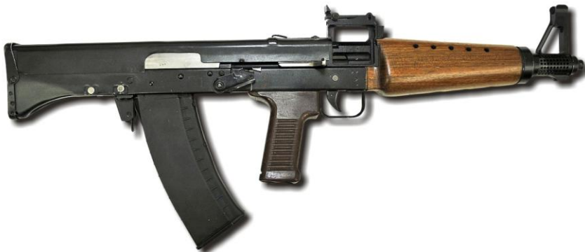
5,45-мм автомат АЛ-2 конструкции Ю. К. Александрова и Р. С. Поваренкина, экспериментальный образец 1960-70-х гг. Ижевский машиностроительный завод. Вместимость магазина 30 патронов, прицельная дальность 1000 м
