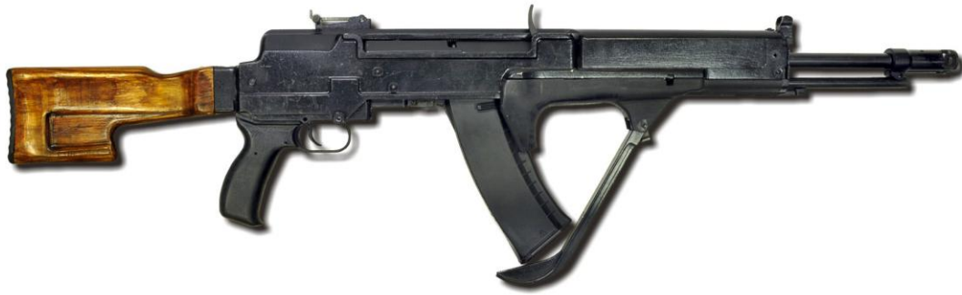
5,45-мм автомат АС конструкции Г. Н. Никонова, опытный образец 1986 г. Ижевский машиностроительный завод. Вместимость магазина 30 патронов, прицельная дальность 1000 м, масса 4,07 кг, темп стрельбы 600/1800 выстр./мин.
