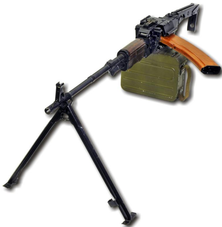
5,45-мм ручной пулемет ПУ-2 конструкции М. Е. Драгунова и В. М. Калашникова, экспериментальный образец 1972-77 гг. Ижевский машиностроительный завод. Вместимость магазина 45 патронов, вместимость патронной ленты 200 патронов, прицельная дальность 1000 м
