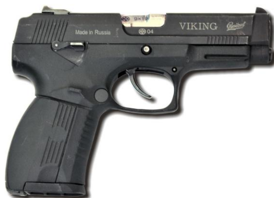
9-мм пистолет МР-446Р «Викинг» конструкции В. А. Ярыгина и Д. Н. Варламова, опытный образец 2000 г. Ижевский механический завод. Вместимость магазина 15 патронов, прицельная дальность 50 м, масса 0,81 кг
