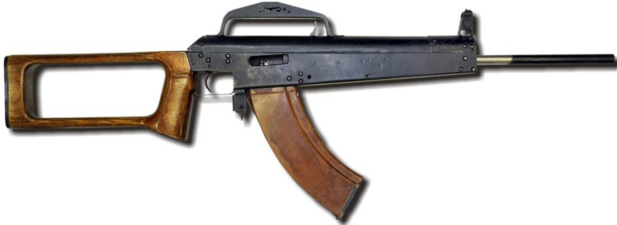
7,62-мм автомат ЛА-3 конструкции Б. М. Зорина, экспериментальный образец 1962 г. Ижевский машиностроительный завод. Вместимость магазина 30 патронов, прицельная дальность 1000 м
