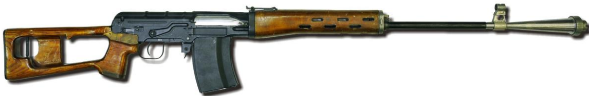
Снайперская винтовка по теме «Финвал» конструкции Н. С. Лукина, экспериментальный образец под 4,5-мм патрон со стреловидной пулей. 1970-е гг. Ижевский машиностроительный завод. Вместимость магазина 15 патронов
