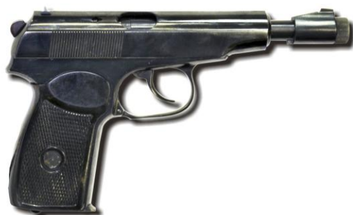
9-мм пистолет ПМ конструкции Л. Л. Горбунова, опытный образец 1968 г. Ижевский механический завод. Вместимость магазина 8 патронов, прицельная дальность 50 м
