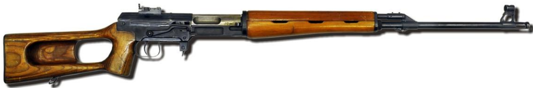
7,62-мм снайперская винтовка ССВ-58 конструкции Е. Ф. Драгунова, опытный образец 1958 г. Ижевский машиностроительный завод. Вместимость магазина 20 патронов, прицельная дальность 1200 м
