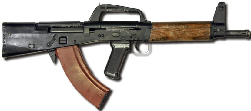
7,62-мм автомат ЛА-4 конструкции А. И. Нестерова, экспериментальный образец 1964 г. Ижевский машиностроительный завод. Вместимость магазина 30 патронов, прицельная дальность 1000 м
