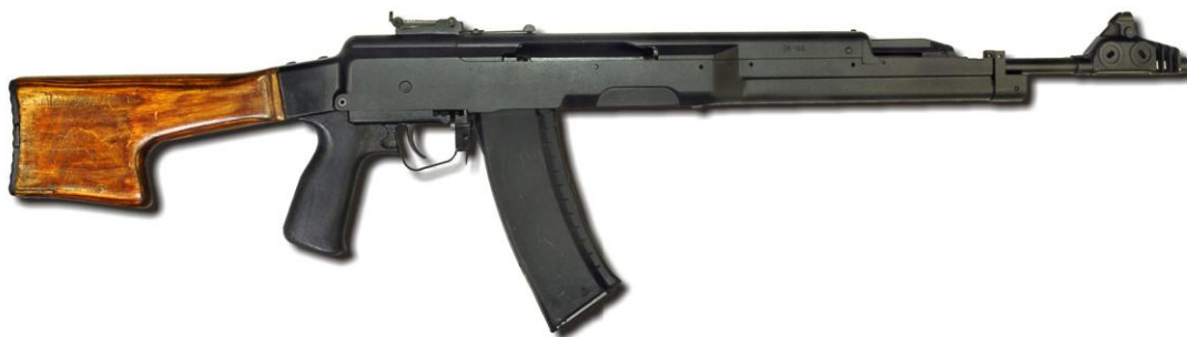
5,45-мм автоматы АСМ конструкции Г. Н. Никонова, опытные образцы 1986-87 гг. Ижевский машиностроительный завод. Вместимость магазина 30 патронов, прицельная дальность 1000 м, темп стрельбы 600/1800 выстр./мин.
