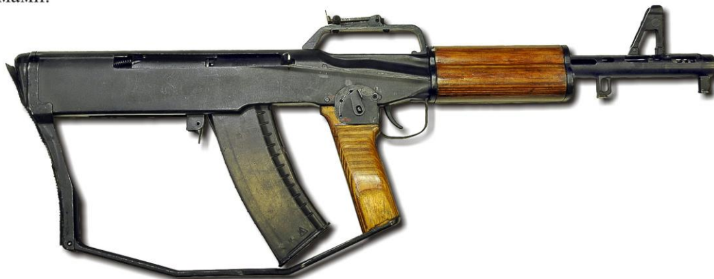
5,45-мм автомат НА-4 конструкции Г. Н. Никонова, экспериментальный образец 1981 г. Ижевский машиностроительный завод. Вместимость магазина 30 патронов, прицельная дальность 1000 м, масса 3,83 кг, темп стрельбы 600/1800 выстр./мин.
