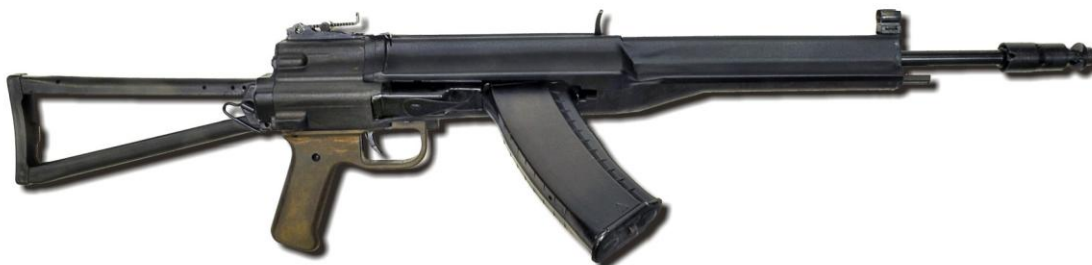
5,45-мм автомат АС конструкции Г. Н. Никонова, опытный образец 1984 г. Ижевский машиностроительный завод. Вместимость магазина 30 патронов, прицельная дальность 1000 м, масса 3,18 кг, темп стрельбы 600/1800 выстр./мин.
