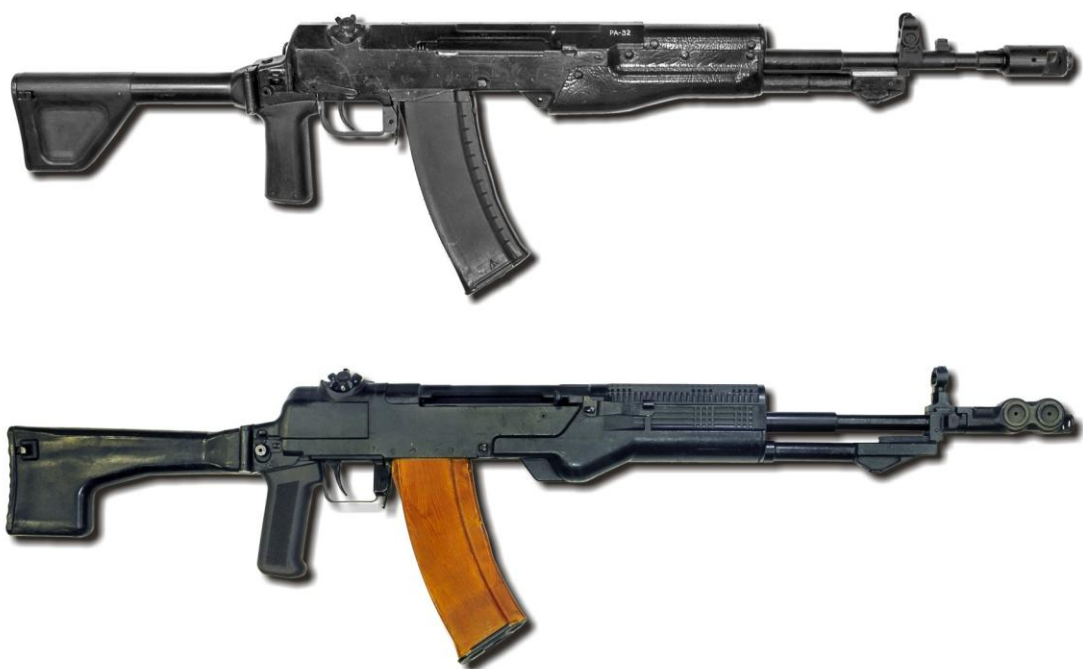
5,45-мм автоматы АСМ конструкции Г. Н. Никонова, опытные образцы 1988-90 гг. Ижевский машиностроительный завод. Вместимость магазина 30 патронов, прицельная дальность 1000 м, темп стрельбы 600/1800 выстр./мин.
